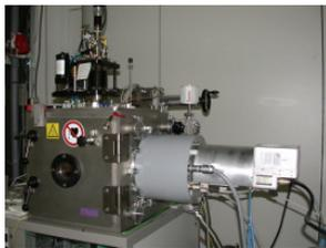
PACVD-Anlage mit Plasmastrahlquelle
